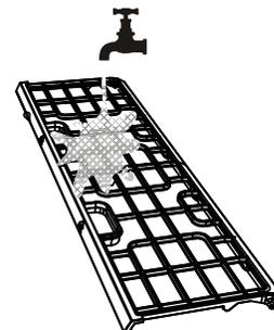
Fig. 15 – Rinçage du filtre
